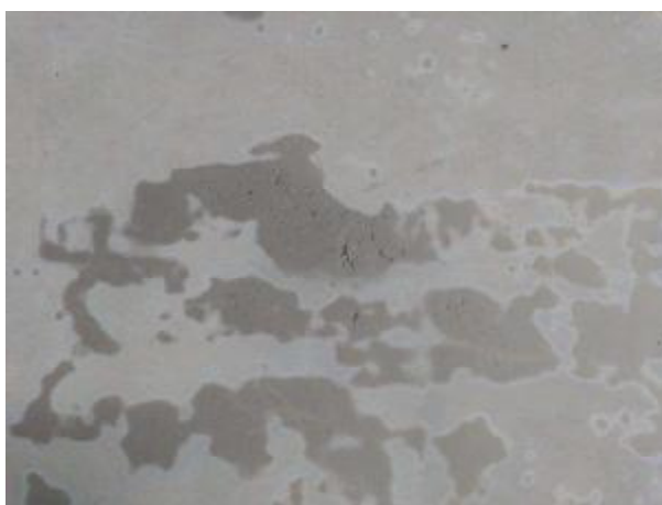
Foto 7 – detail degradace folie včetně popraskání
